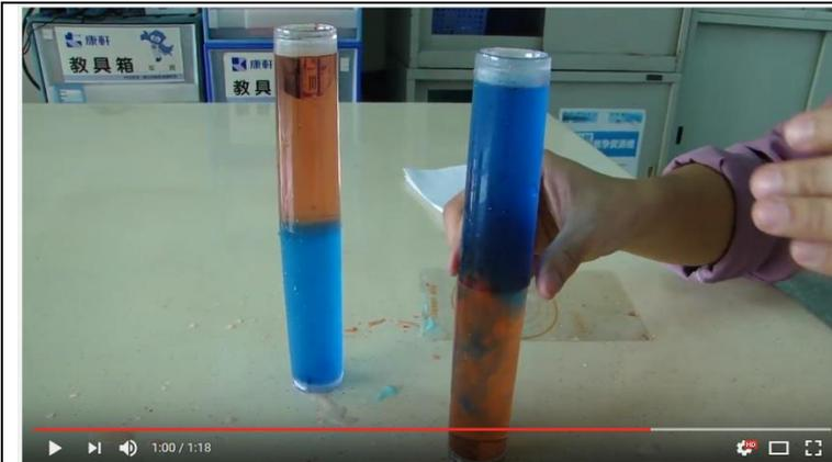
接著抽開膠片，發現冷水往下移動，熱水往上移，兩者呈現混合狀況。
