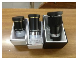
展示教具 45°正像鏡和天頂鏡(左)、不同焦距的目鏡(中)、X3 增倍鏡(右)
