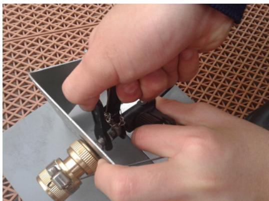
圖八:把手打泵安裝在發射器上
