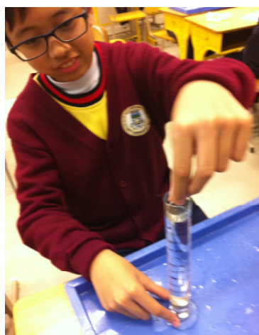
以一元硬幣測量水的表面張力
